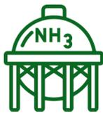
L'ammoniac est stocké sous forme liquide à température ambiante sous forme comprimée (16-18 bars) ou à basse température (-33 °C) et pression ambiante.
